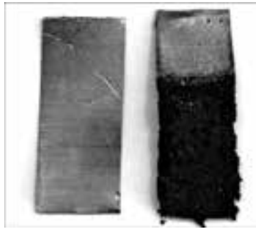
Abb. 5: Graphitfolie; links: vor der Elektrolyse; rechts: nach der Elektrolyse
