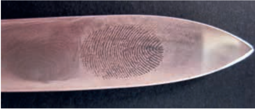
■ Abb. 4: Sichtbarer Fingerabdruck nach Elektrolyse in einer Kupfersulfat-Lösung auf einer Messerklinge aus Stahl
