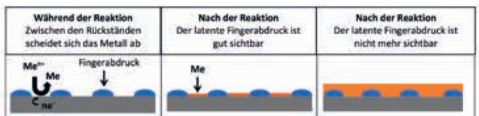
■ Abb. 2: Schematische Darstellung einer Metallplatte (grau) und des darauf befindlichen Fingerabdrucks (blau) im Querschnitt. Reduktion eines Metallsalzes beim Kontakt mit der Metallplatte (links). Abgeschiedenes Metall nach einer Zementation bzw. Elektrolyse (rechts)
