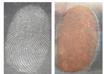
■ Abb. 3: Sichtbarer Fingerabdruck nach der Kupferzementation auf einem Zinkblech (links) und einer Zinkelektrolyse auf einem Kupferblech (rechts)
